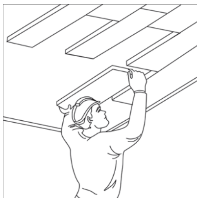
Рисунок 6.11 – Установка плит теплоизоляционных на перекрытие
